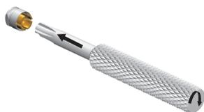
Для активации, деактивации и извлечения пластинчатой ретенционной вставки требуется отвертка / активатор (№ по каталогу: 072 609). Инструмент с четырьмя выступами устанавливают в необходимое положение и до упора продвигают в пластинчатую ретенционную вставку.
