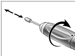
❶ Ruotare verso destra la guaina anteriore dell'impugnatura fino al suo arresto. Inserire l'utensile rotante fino a finecorsa, oppure estrarlo.
