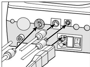
**1** Collegare il cavo per motore, l'elemento di impostazione, il comando a pedale, il tubo dell'aria (Perfecta 600) e il cavo di alimentazione.
