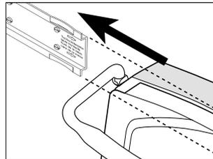
**3** Inserire l'apparecchiatura fino all'arresto sulla lamiera di supporto.
