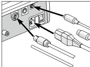
**1** Collegare il cavo per motore, l'elemento di impostazione (opzionale), il tubo dell'aria (Perfecta 600)
