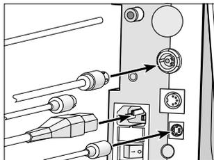
**2** Collegare il cavo per motore, l'elemento di impostazione, il tubo dell'aria (Perfecta 600), il comando a pedale e il cavo di alimentazione.
