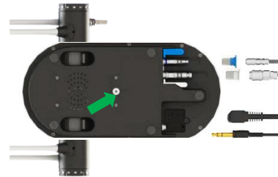
Master Screw -ruuvien sijainti
