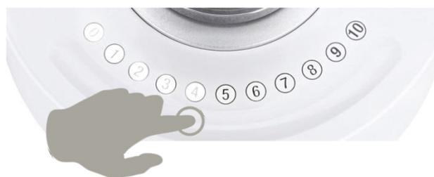
Porre il dito nella scanalatura sotto i numeri per regolare la pressione dell'aria dell'AIRFLOW® e la potenza del PIEZON®:
