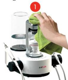
**1** Pulire la superficie esterna del dispositivo con un panno e alcool
