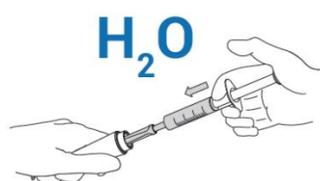
❗ Sciacquare i condotti interni centrali nella normale direzione del flusso (nessun risciacquo a flusso invertito) utilizzando Easy Clean con una siringa monouso riempita con più di 2 ml d'acqua potabile
