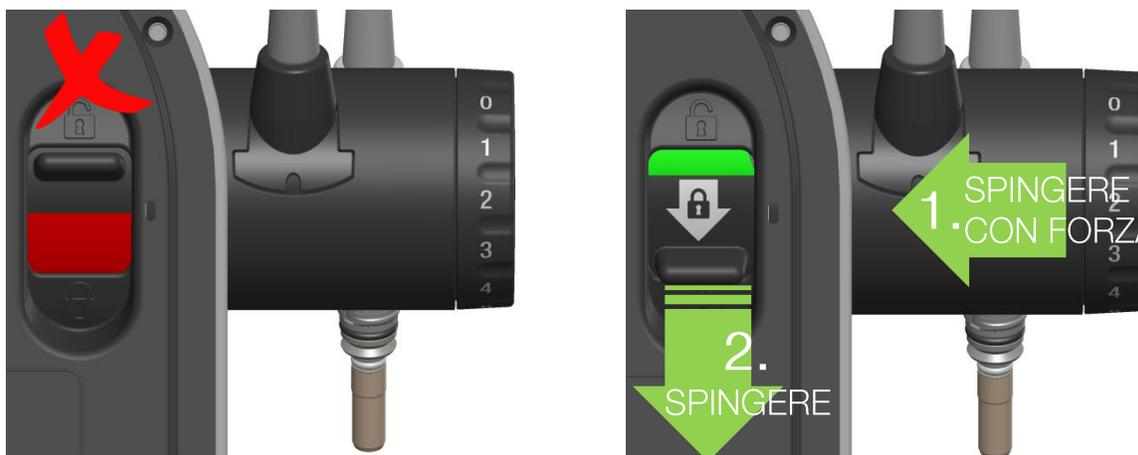
Il cavo del manipolo non è completamente connesso. **SPINGERE CON FORZA** per bloccarlo in posizione. Il sistema è correttamente connesso e bloccato.
