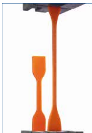
Dehnung von V-Posil X-Light Fast
